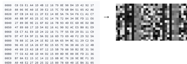
FIGURE 2 – Passage d'un fragment en octet bruts (tronqué) à une image en niveaux de gris
